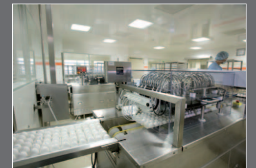
Die Produktion von Grippeimpfstoffen: Die Brutierer werden mit einer virushaltigen Lösung beimpft.
