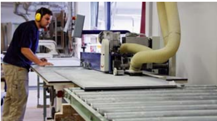
Foldinganlage für den Wandanschluss von Waschtischen und Arbeitsplatten
