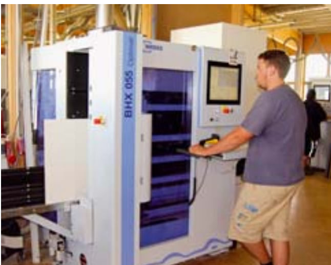
Benötigt im Vergleich zur Auslegermaschine nur ein Siebtel der Energie: der Korpuspezialist BHX 055 von Weeke
