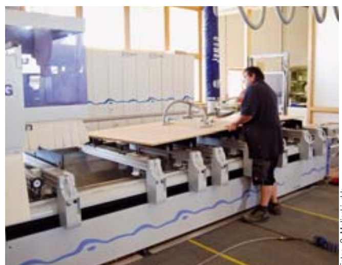
Vermeidet Wartezeiten mit vier Meter langem, wechselbeschickbarem Tisch und Werkzeugwechselzeiten mit fünfter Achse: die BOF 211 Edition L
