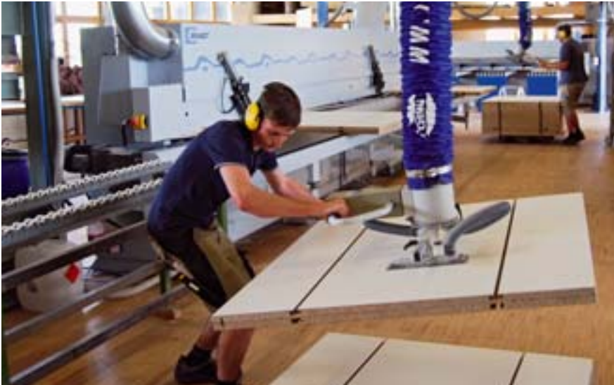
Schneller als bisher, erlaubt flinke Farbwechsel und 20-Millimeter-Anleimer: die Highflex 1880 von Brandt
