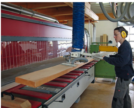
... und bringt den Abschnitt mit dem Jumbo zur neuen Längskreissäge
