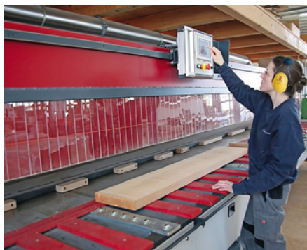
Nach dem Laser hat sie das Brett besäumt und wählt das Programm Anleimer
