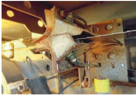
Sauberkeit ist Pflicht! Filzblöcke reinigen, schmieren und kühlen
