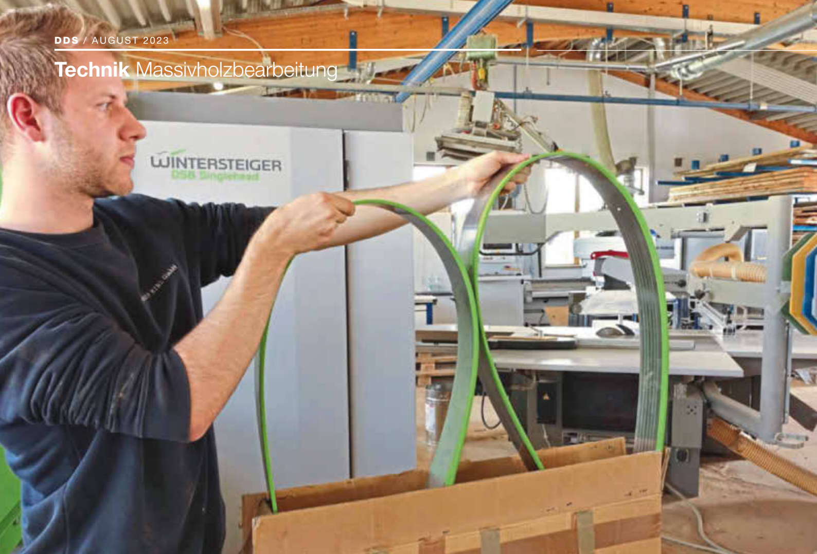
Das grüne Kunststoffprofil schützt Schneiden und Schreiner beim Hantieren und Verpacken
