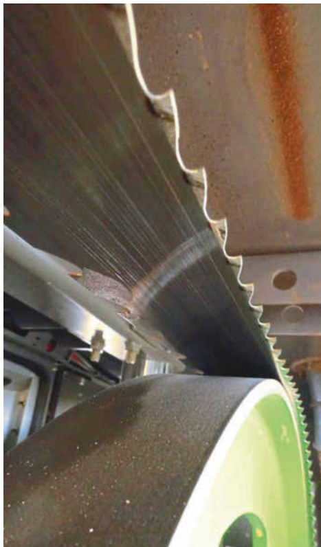
Vorne trennen die Schneiden, hinten putzen die Spanlücken
