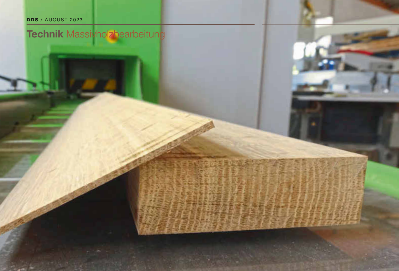
Wunschdicken ab 1,8 mm: Die Dünnschnitt-Bandsäge liefert perfekte, verleimfähige Schnitte
