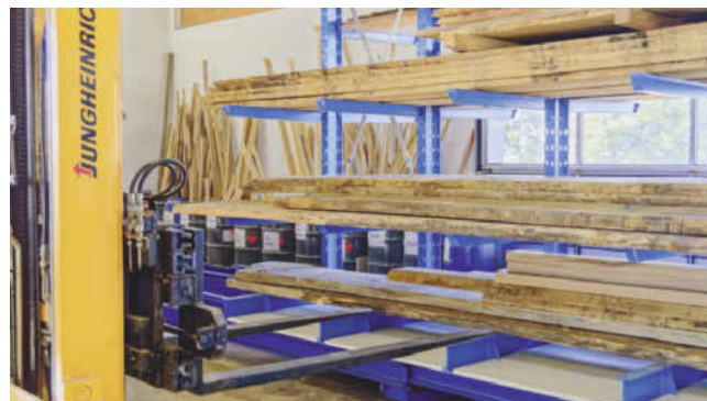
... und entnimmt die Bretter mit dem Gabelstapler
